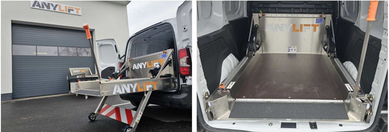
Links: ausgefahrenes System am Fahrzeug. Rechts: Integration im Laderaum mit nutzbarer Plattformfläche.
