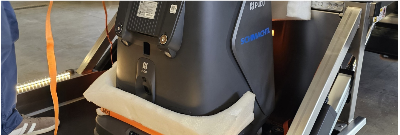
Praxisbeispiel für erreichbare Zurrpunkte und Sicherung einer rollbaren Last auf der Plattform.
