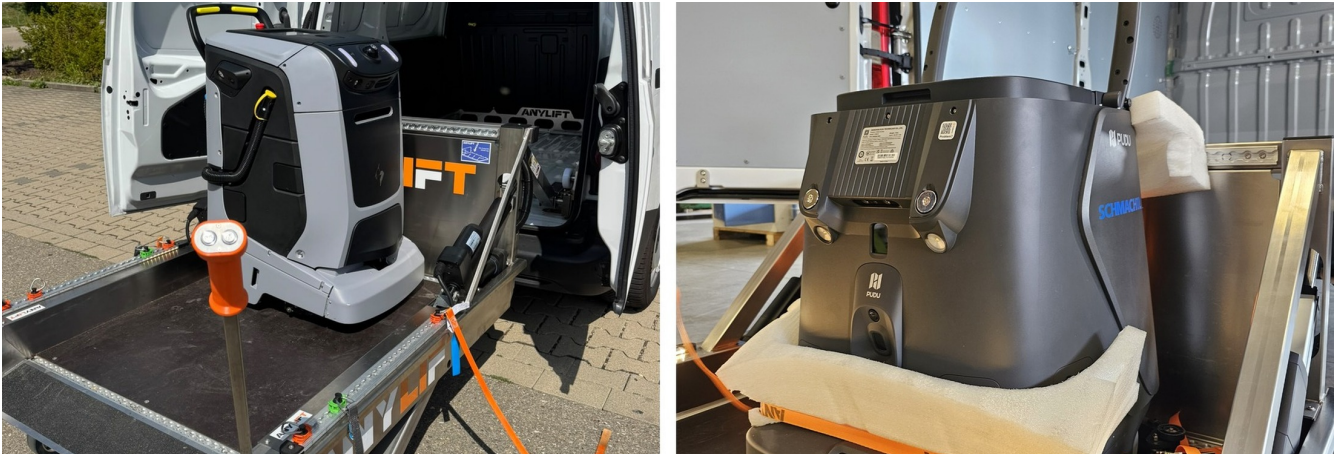
Links: Roboter auf der Plattform. Rechts: gepolsterte Positionierung und Sicherung im Fahrzeug.
