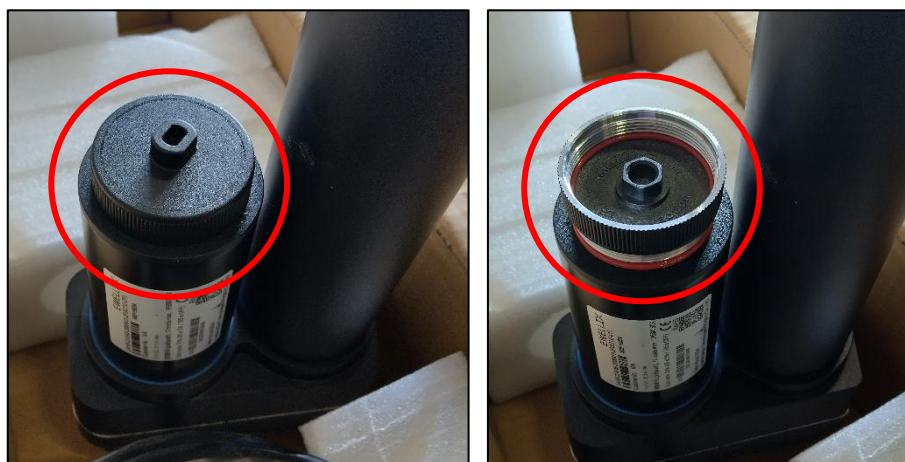
Abbildung 14: Manueller Notbetrieb vom Linearmotor Links: Deckel vom Linearmotor Rechts: Deckel ist umgedreht und aufgesteckt.
