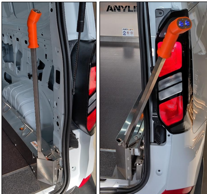
Abbildung 2: Stellungen des Bedienhebels Links: Gesichter Zustand: Hebel eingeklappt, System ausgeschaltet Rechts: Normalbetrieb: Hebel ausgeklappt, System eingeschaltet
