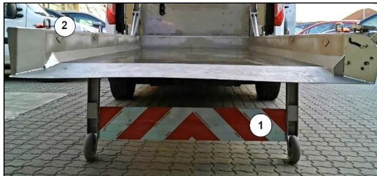
Abbildung 1: Reflektor am hinteren Bereich der Hubladeplattform (1) und zwei Warnblinkleuchten auf der Hubladeplattform (2) (Abbildung kann abweichend sein).
