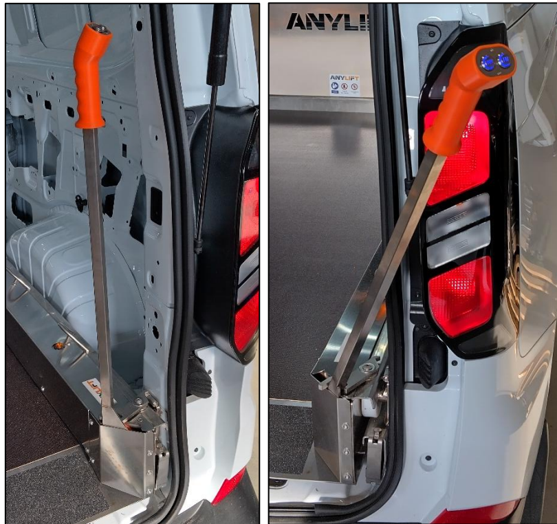
Abbildung 2: Stellungen vom Bedienhebel Links: im eingeklappten/ausgeschalteten Zustand. Rechts: im ausgeklappten/eingeschalteten Zustand
