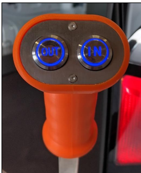
Abbildung 3: Bedienhebel des Hubladesystems im eingeschalten Zustand
