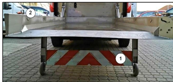
Abbildung 1: Reflektor am hinteren Bereich der Hubladeplattform (1) und Warnblinkanlage auf der Hubladeplattform (2) (Abbildung kann abweichend sein).
