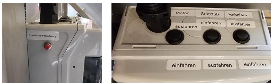
Abbildung 10: Manuelle Notbedienung, Zweihandbedienung: Roter Taster gibt Funktionstaster frei
