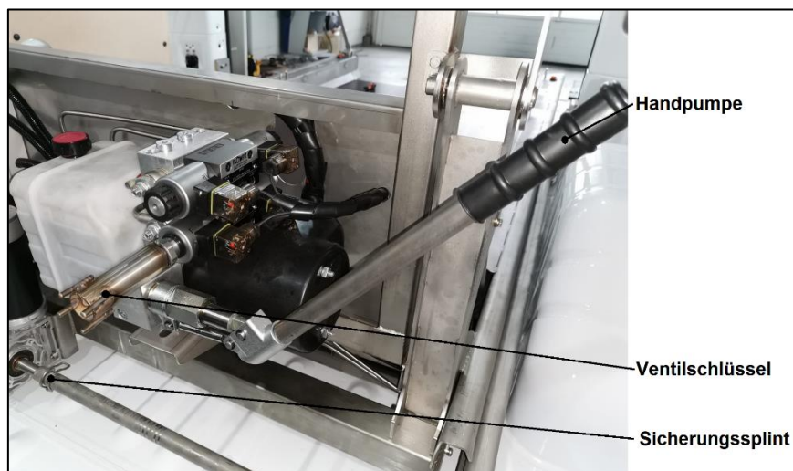
Abbildung 10: Handpumpe zur Erzeugung des notwendigen Betriebsdruck im Störbetrieb und Ventilschlüssel zur Betätigung des erforderlichen Ventils
