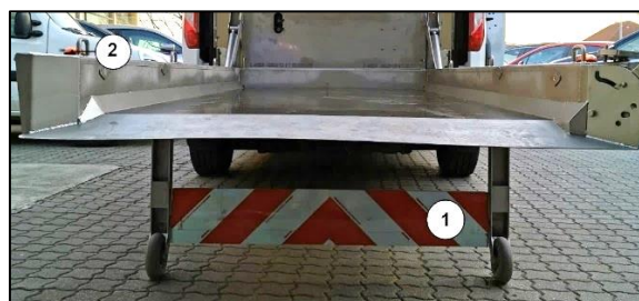
Abbildung 1: Reflektor am hinteren Bereich der Hubladeplattform (1) und Warnblickanlage auf der Hubladeplattform (2) (Abbildung kann abweichend sein).
