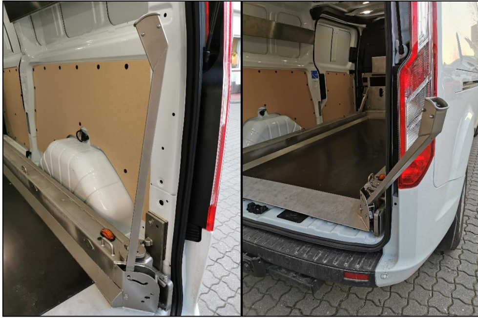
Abbildung 3: Bedienhebel im gesicherten (links) und im entsicherten (rechts) Zustand.
