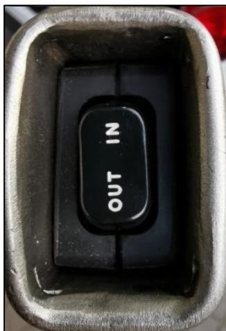
Abbildung 4: Kippschalter zur Bedienung des Hubladesystem. (Abbildung kann abweichen)
