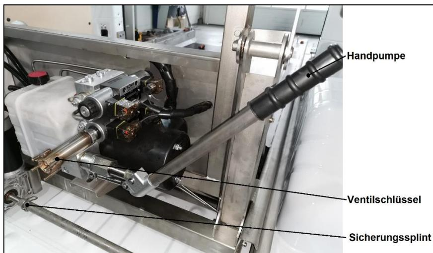
Abbildung 10: Handpumpe zur Erzeugung des notwendigen Betriebsdruck im Störbetrieb und Ventilschlüssel zur Betätigung des erforderlichen Ventils
