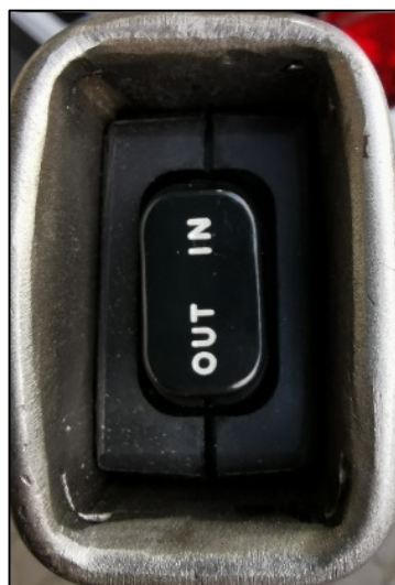
Abbildung 4: Kippschalter zur Bedienung des Hubladesystem.
